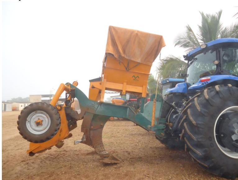
FIGURA 1: Equipamento “Penta” que realiza o preparo profundo encanteirado. O delineamento foi de blocos em faixas onde cada faixa correspondia a uma parcela experimental, totalizando 4 parcelas por tratamento. Cada uma dessas parcelas contava com 6 canteiros de 100
