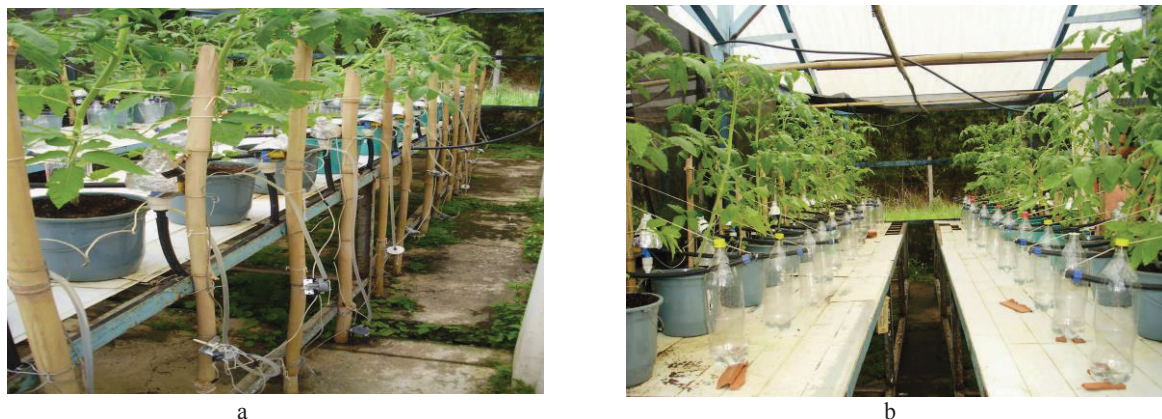
FIGURA 1. Esquema do experimento montado em casa de vegetação: Diferentes desníveis do pressostato e em relação à cápsula (a) e coletores do volume de água aplicado (b).
