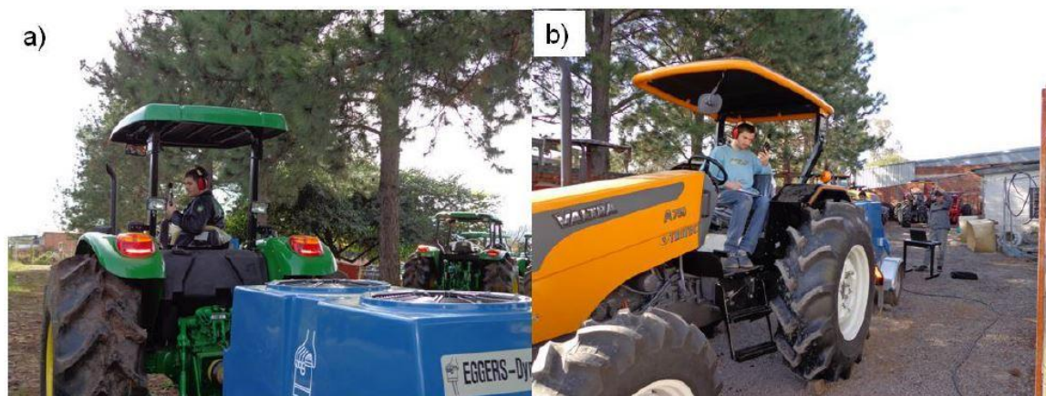
FIGURA 1. Medição do nível de ruído que chega ao ouvido do operador (a); e procedimento utilizado para realização de tal medição (b).
