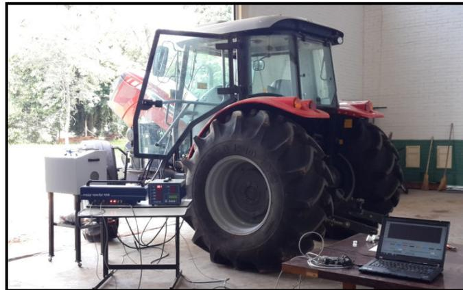
FIGURA 1. Trator utilizado no experimento já instrumentado com o analisador de gases.
