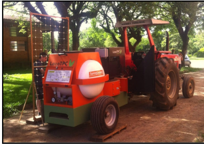
FIGURA 3. Grade com pontos de medição da velocidade e temperatura do fluxo de ar gerado pela máquina Lazo TPC.
