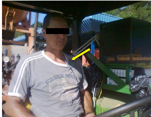
FIGURA 4. Posicionamento do microfone do dosímetro durante a coleta de dados.
