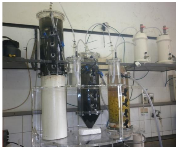
Figura 1: Sistema de tratamento em escala laboratorial compreendendo associação em série dos reatores UASB com o FBS instalado no LADEG
