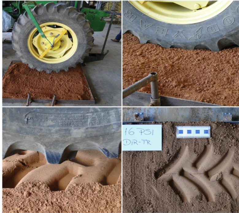
FIGURA 1. Procedimento adotado para determinação da área de contato entre os pneus usados no experimento e o solo.
