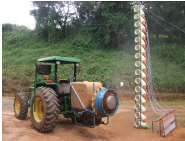
Figura 1. Coletor vertical usado na determinação da uniformidade de distribuição volumétrica.
