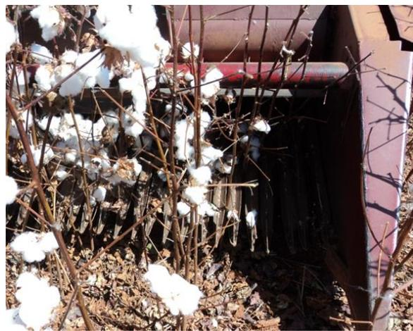
FIGURA 2. Plataforma Stripper de Pente
