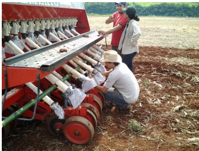
FIGURA 1. Semeadora-adubadora de fluxo contínuo equipada com os sacos plásticos para coleta de sementes depositadas.
