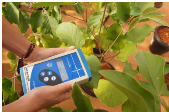
FIGURA 1. Leituras indiretas do índice de clorofila Falker (ICF), por meio do clorofilômetro, no corte do feijão-de-porco ( Canavalia ensiformis L.)
