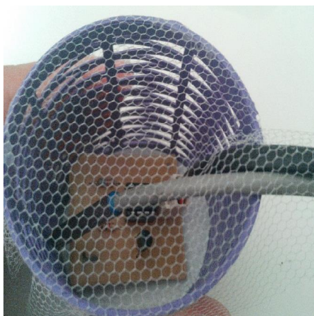
FIGURA 2. Sensores de temperatura de data logger desenvolvido e data logger comercial.
