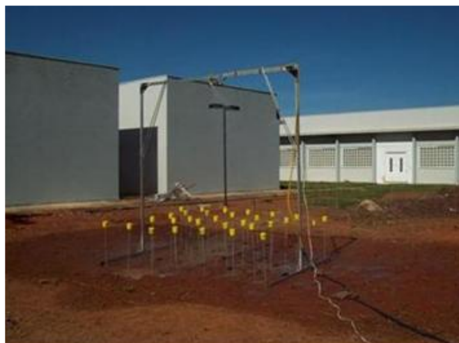
FIGURA 1. Vista geral do simulador de chuva em teste de lâmina d'água. Rondonópolis, MT 2011
