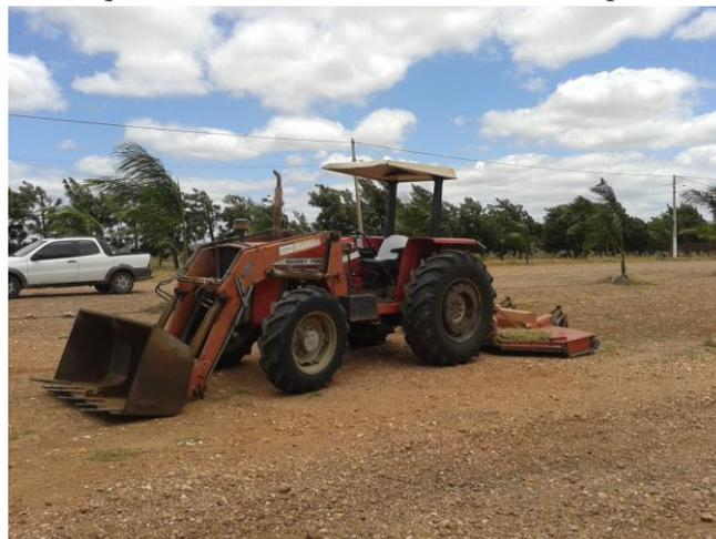
Figura 1. Conjunto mecanizado Trator-Segadora
