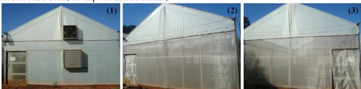
**Figura 1:** Casas de vegetação (1 ou A) fechada, com ventilação mecânica, resfriamento evaporativo e tela termorrefletora móvel; (2 ou C) aberta, revestida com tela antiafídeo e tela termorrefletora fixa; (3 ou B) aberta, revestida com tela antiafídeo e tela termorrefletora móvel.
