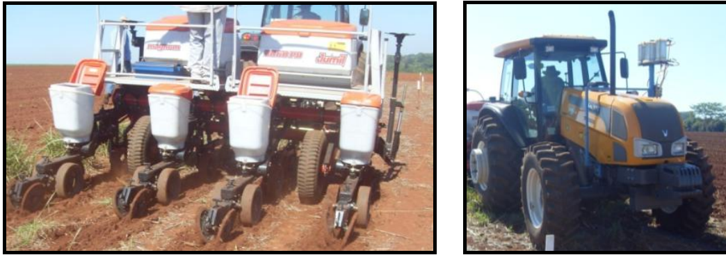
Figura 1. Conjunto Semeador e Trator utilizados no experimento.
