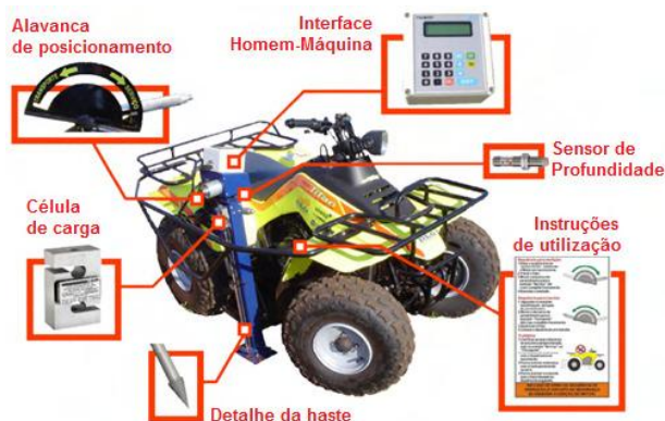
FIGURA 1. Equipamento utilizado para as aferições de RMSP.
