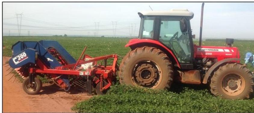
FIGURA 1. Conjunto trator x arrancador-invertedor.
