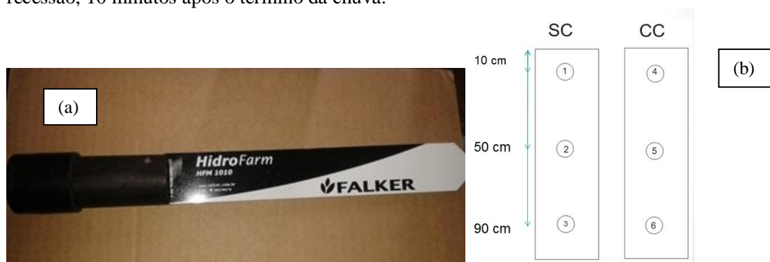
FIGURA 1. Sensor de umidade Falker HFM 1010 (a) e distribuição dos sensores nas parcelas (b)
