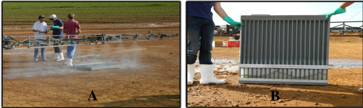
Figura 2 - Coleta de calda para determinação da uniformidade de distribuição volumétrica (A). Mesa posicionada na posição vertical para a coleta (B).
