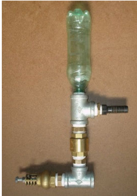
Figura 4. Carneiro hidráulico construído com garrafa PET e algumas peças especiais.
