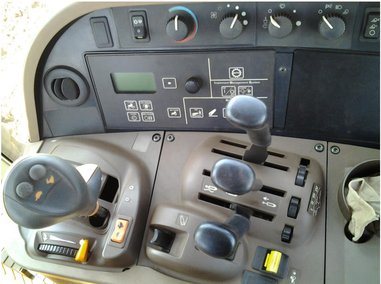
FIGURA 1. Alavancas de comando do trator e painel do computador de bordo. (Paludo Ago/2013).
