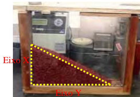
FIGURA 4. Estrutura para medição do ângulo de repouso de sementes.
