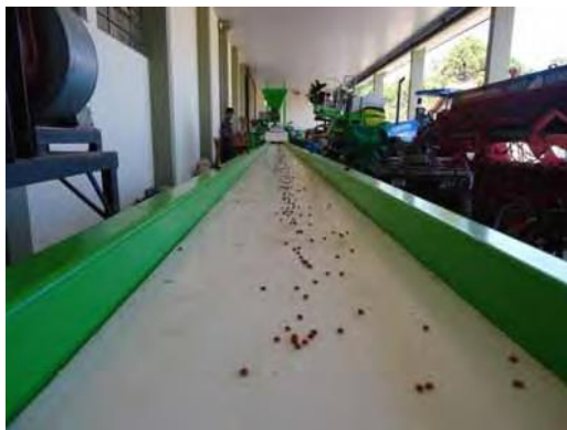
FIGURA 2. Esteira de deposição e distribuição de sementes, possui 10 m de comprimento.
