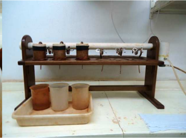
Figura 2. Permeômetro de carga hidráulica constante – DRNPA; CCA – UFSCar – Araras – SP.
