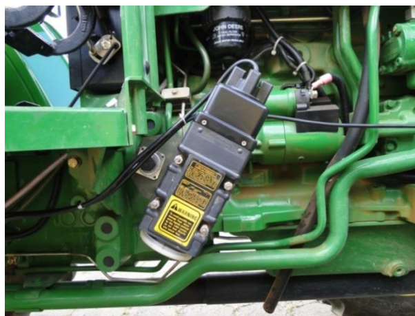
FIGURA 1. Unidade de radar utilizado para medição da velocidade de deslocamento do conjunto.
