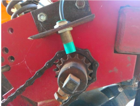
FIGURA 1. Transdutor indutivo utilizado para determinar a velocidade angular das rodas de acionamento da semeadora-adubadora.
