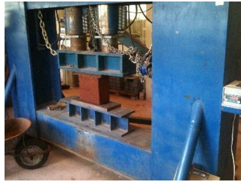
FIGURA 6. Corpo de prova no ensaio de compressão simples (a e b).
