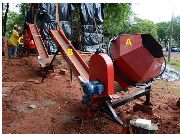
FIGURA 5. Misturador (A), esteiras (B), triturador (C).
