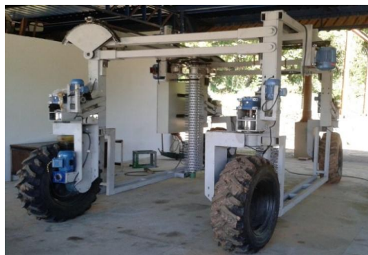
Figura 1 – Colhedora de café para terrenos montanhosos em desenvolvimento no LMA
