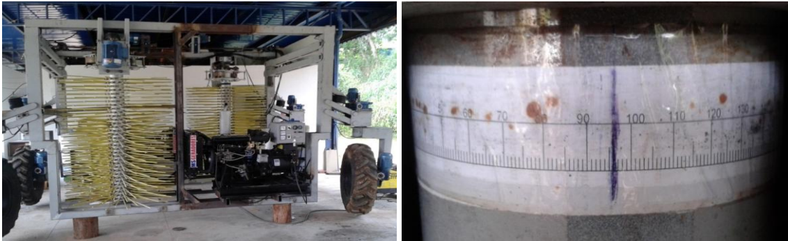
Figura 3 – (a) Máquina colhedora apoiada sobre suportes de madeira e (b) Escala de marcação deslizante para marcação dos ângulos da roda
