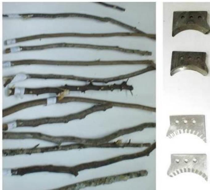
FIGURA 7. Fotografia dos dois tipos de navalhas testadas no módulo de poda: a navalha com o fio de corte liso e a navalha com o fio de corte estriado.
