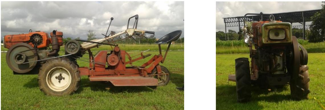
**FIGURA 1.** Trator de Rabiça utilizado nas medições da emissão do nível de ruído
