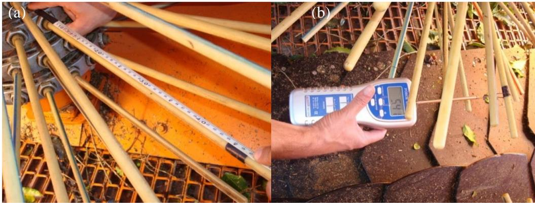
**Figura 1.** Medição da força que ocasiona o torque (a) Local de medição da força (b) Dinamômetro portátil utilizado para quantificar a força. **Measuring the force that causes the torque (a) Place of force measurement (b) Portable Dynamometer used to quantify the strength.**
