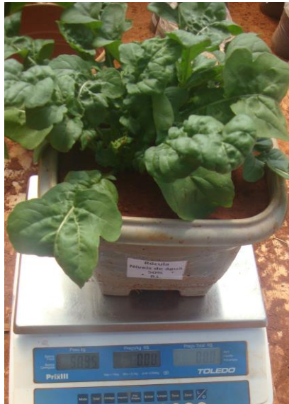
FIGURA 1. Determinação da evapotranspiração da cultura da rúcula por meio de pesagem em balança eletrônica.
