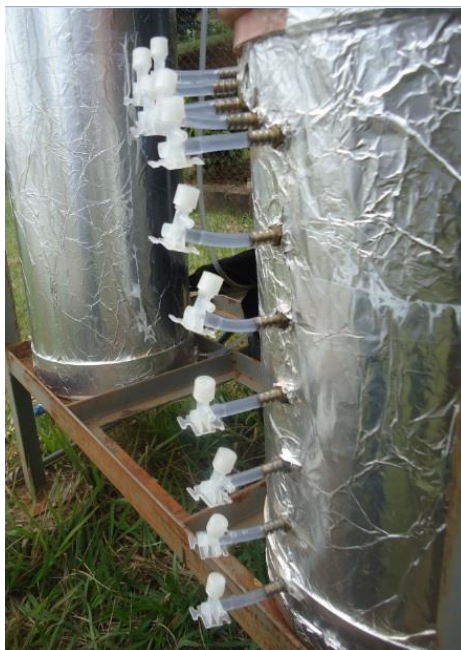
FIGURA 3. Pontos de amostragem distribuídos ao longo do meio filtrante de não tecido sintético.
