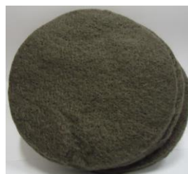
FIGURA 2. Discos de náotecido sintético, com 250 mm de diâmetro.
