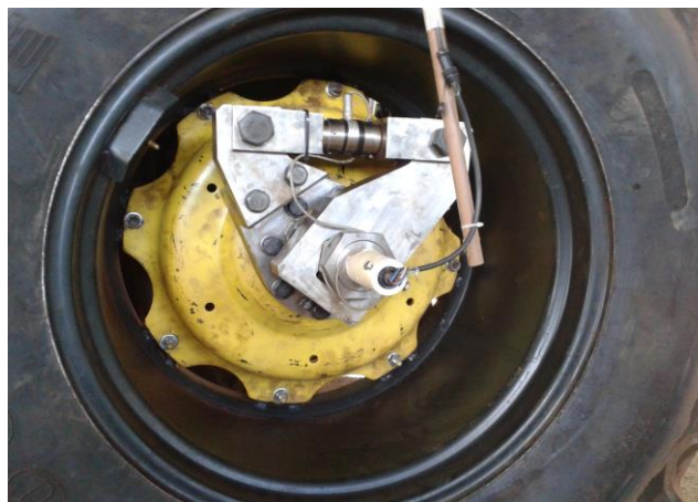
FIGURA 4. Torciômetro montado no eixo e na roda traseira do trator.
