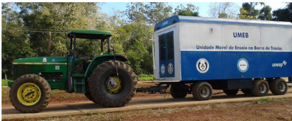
FIGURA 2. Trator instrumentado e com torçômetro montado na roda, acoplado a UMEB através da barra de tração sobre pista de concreto.
