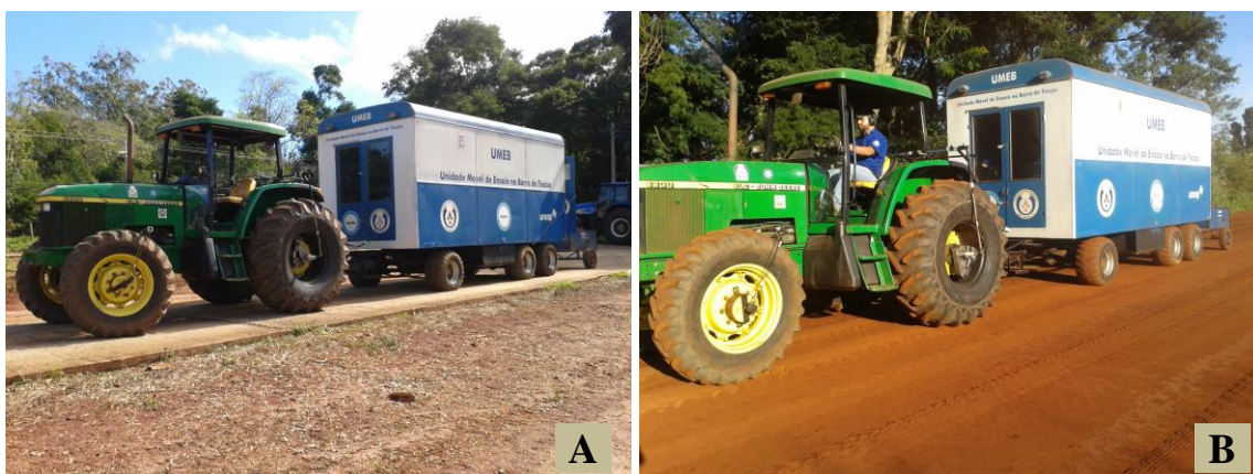
FIGURA 2. Trator de ensaios instrumentado, acoplado através da barra de tração na Unidade Móvel de Ensaio na Barra de Tração (UMEB), sobre pista de concreto (A) e sobre pista de solo firme (B).
