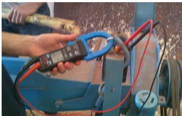
FIGURA 3 - Medição da potência da picadora utilizando-se o wattímetro.
