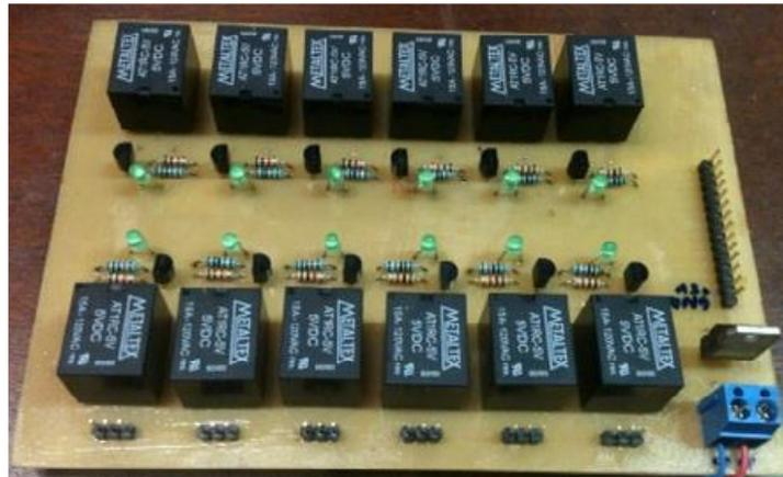
**Figura 2:** Foto mostrando placa de acionamento.
