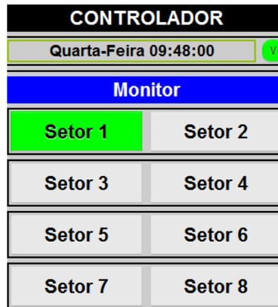
**Figura 5:** Tela principal do aplicativo indicando que o setor 1 esta sendo irrigado no momento.
