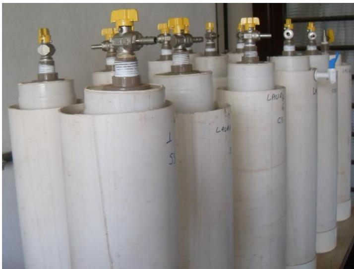
Figura 2 – Biodigestores experimental modelo batelada.
