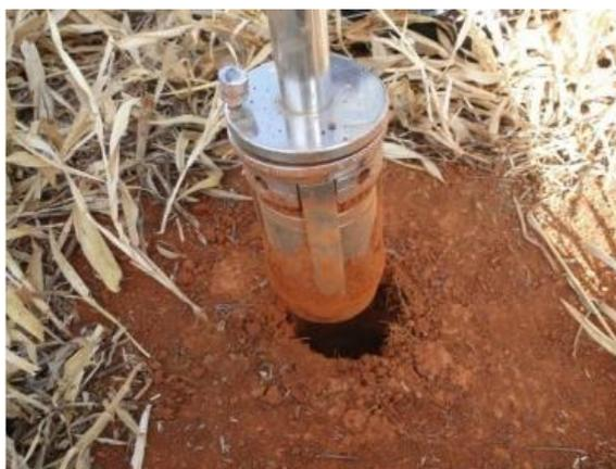
FIGURA 2. Trado utilizado e operação de retirada de amostras indeformadas.
