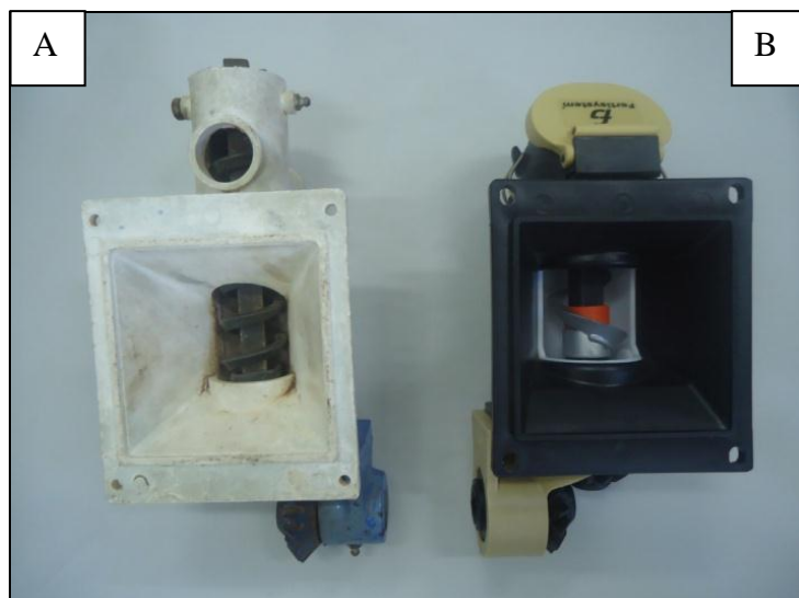
Figura 1. A) dosador de fertilizante helicoidal por gravidade; B) dosador helicoidal por transbordo (Fertisystem).
