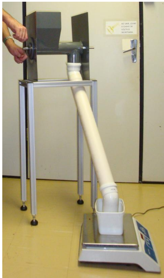
FIGURA 8. Testes do protótipo da máquina para alimentação automática de pequenos animais.
